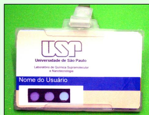
Fig.3. Dosímetro exibindo resposta em vários tempos de exposição ao UV ambiental.
